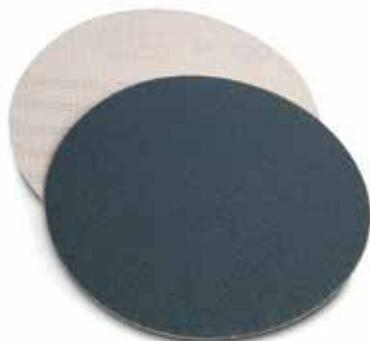
Abrasivo molto duro e resistente, ad alte prestazioni, disponibile in dischi di vari formati senza fori con attacco velcro. Abrasivo all'ossido di zirconio, legante doppia resina, cosparsione chiusa, supporto in carta peso F. Indicato per la sgrossatura e levigatura a macchina a secco su metalli, acciaio inox, leghe, titanio, legni duri, fibra di vetro. Settori di impiego: Industria del Metallo, Legno, Carrozzeria, Nautica, Vetroresina.
